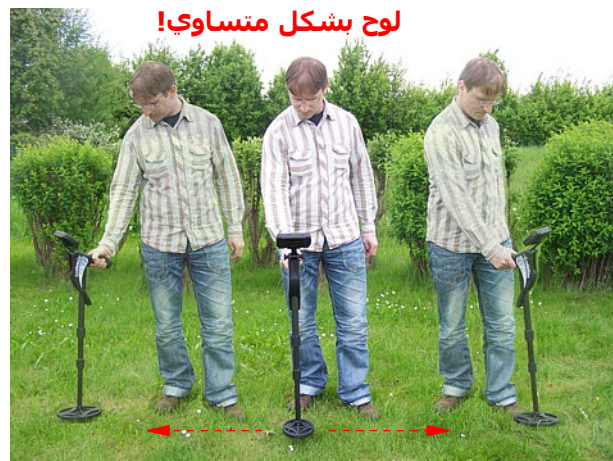
الرسم 7.6: القيام بضبط الجهاز
