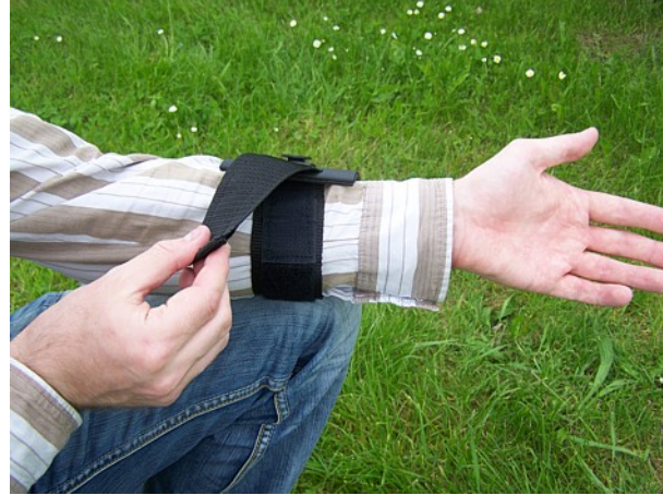
الرسم 6.8: تثبيت وحدة التحكم على معدات التثبيت على الساعد (أ)
