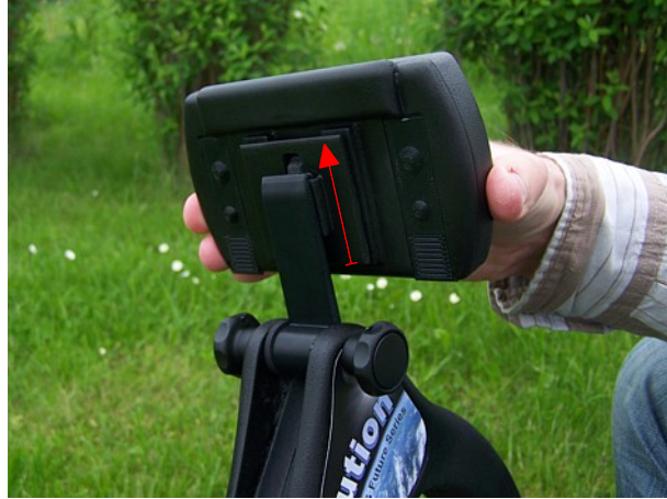
الرسم 6.7: تثبيت وحدة التحكم على المجس (ب)
