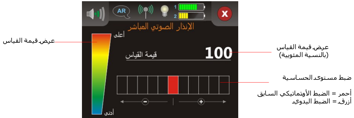
الرسم 7.8: ضبط حساسية الكاشف عن المعادن
