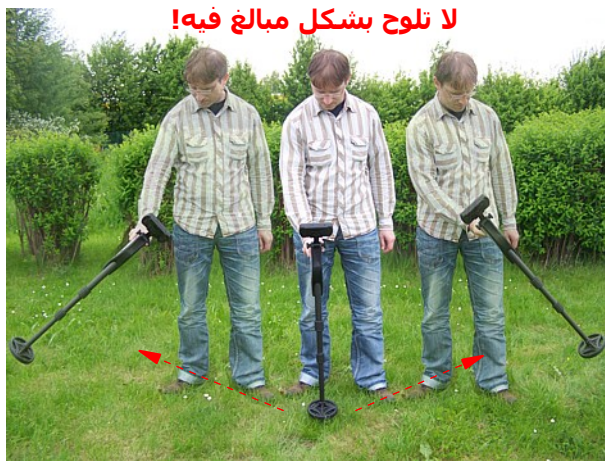
الرسم 7.6: القيام بضبط الجهاز
