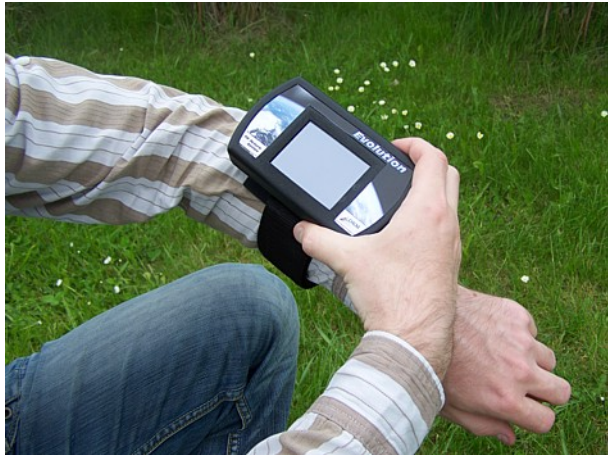
الرسم 6.9: تثبيت وحدة التحكم على معدات التثبيت على الساعد (ب)
