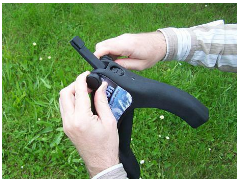
Figura 22: Coloque la unidad de control en la punta de prueba (a)
