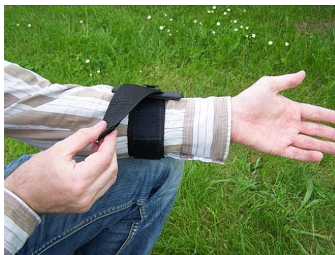
Figura 25: Coloque la unidad de control en el titular de la muñeca (b)
