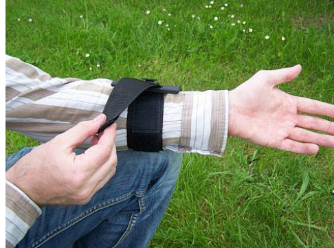
Figura 16: Montaje de la unidad de control a la titular de la muñeca
