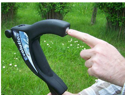
Figura 22: Coloque la unidad de control en la punta de prueba (a)
