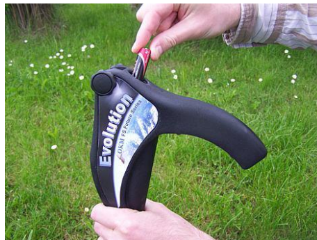
Figura 19: Coloque las baterías en la sonda telescópica
