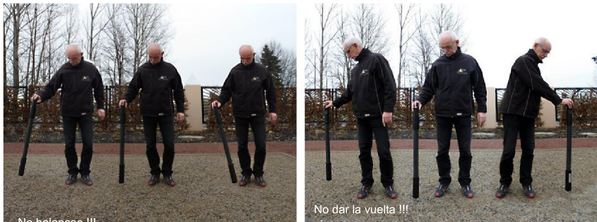
Figura 7.9: pivotante o de inflexi6n de la sonda falsifies la medici6n
