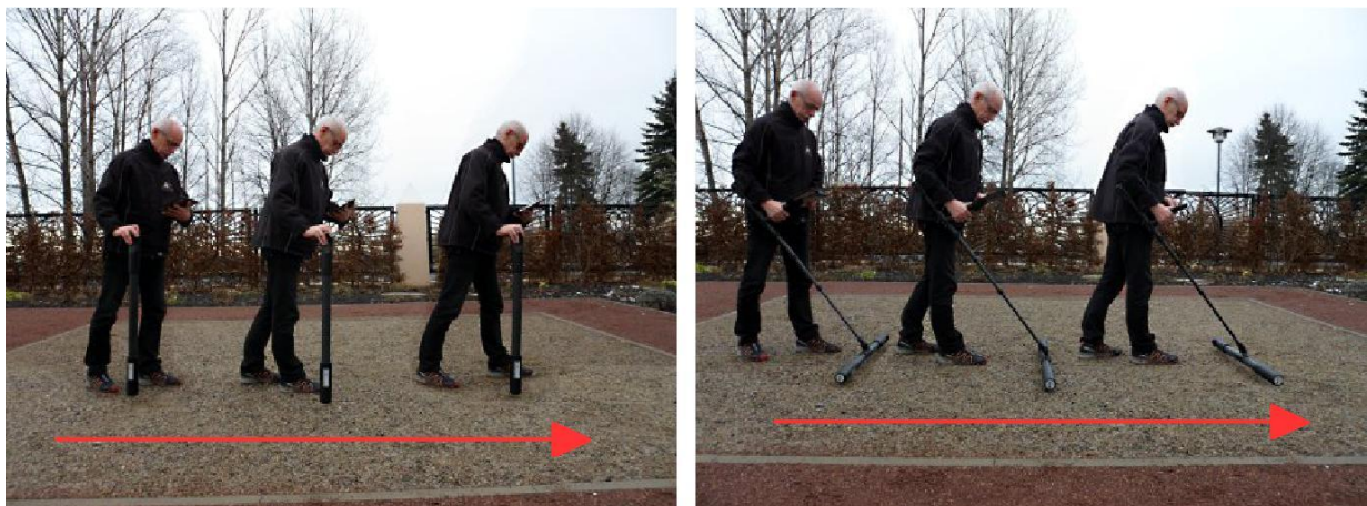
Figura 7.5: exploración de la tierra en el modo vertical y horizontal Figura 7.4:
