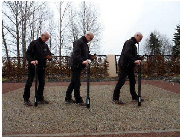
Figura 7.8: sonda siempre debe apuntar hacia abajo y no debe ser volvi6
