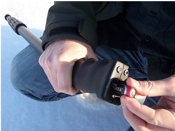
Abbildung 5.1: Batterien in die Teleskopsonde einlegen
