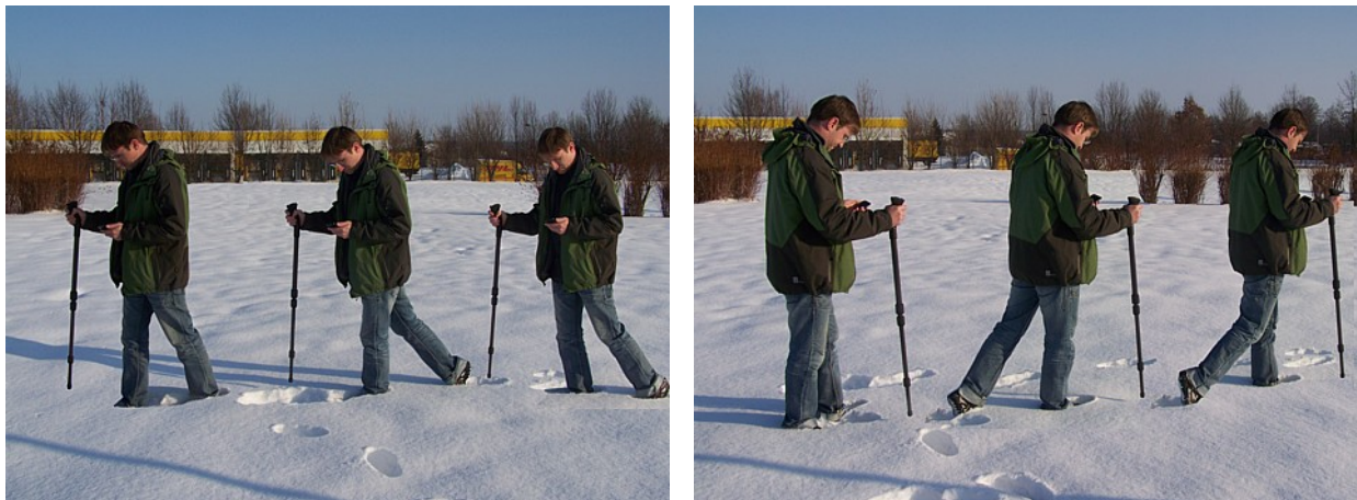
Abbildung 7.6: "Zig-Zag" Messung in der Betriebsart "3D Bodenscan"
