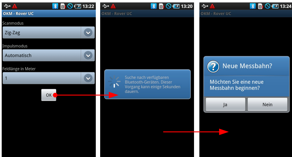
Abbildung 7.5: Betriebsart "3D Bodenscan" ausführen
