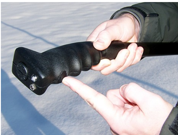
Figure 5.3: Démarrer la sonde télescopique
