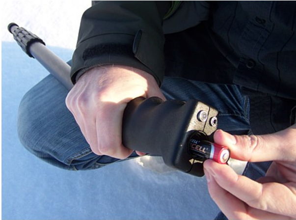
Figure 5.1: Placer les piles dans la sonde télescopique
