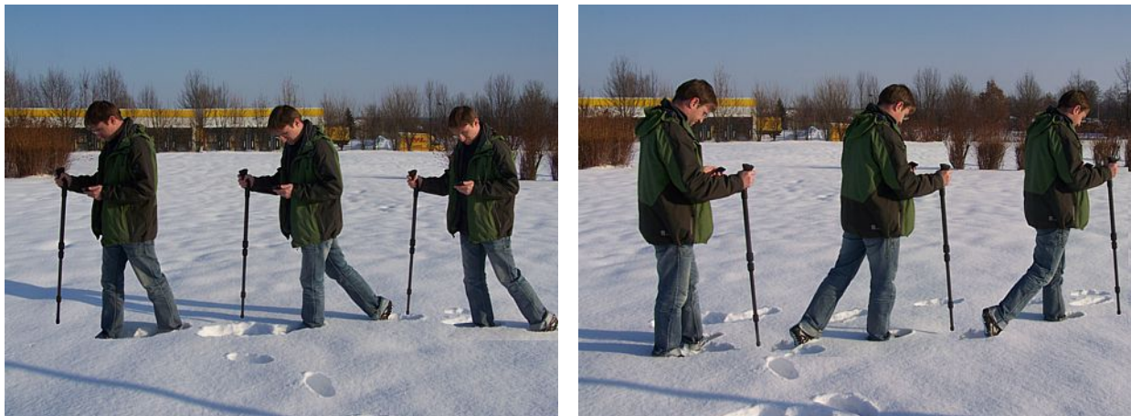
Abbildung 7.7: "Zig-Zag" Messung in der Betriebsart "3D Bodenscan"
