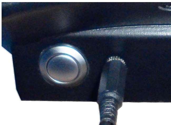
Illustration 5.4 : connexion du joystick
