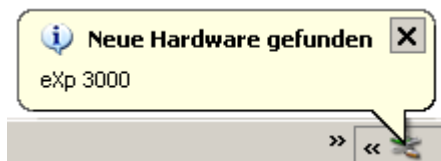
Illustration 2.1 : Installation des pilotes USB : Windows XP, étape 1
