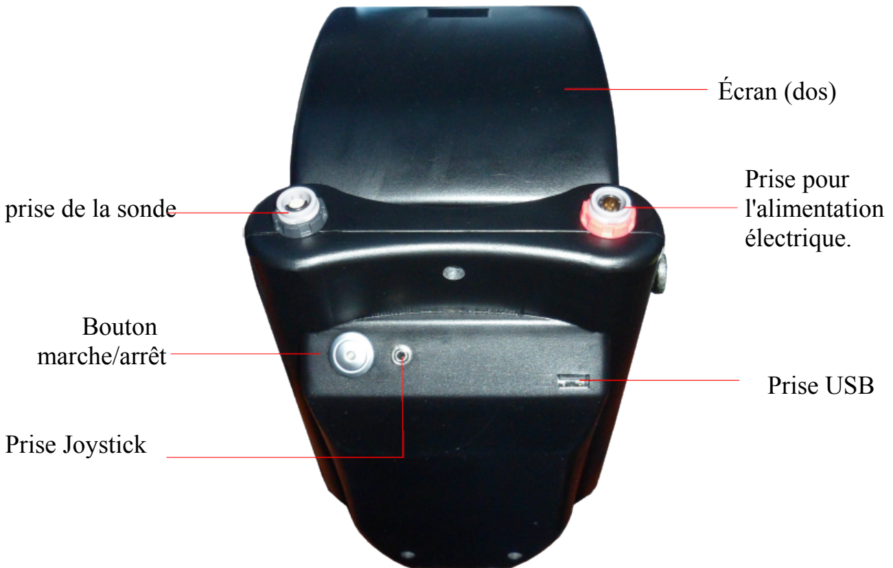
Illustration 6.3 : boîtier de contrôle, vue arrière
