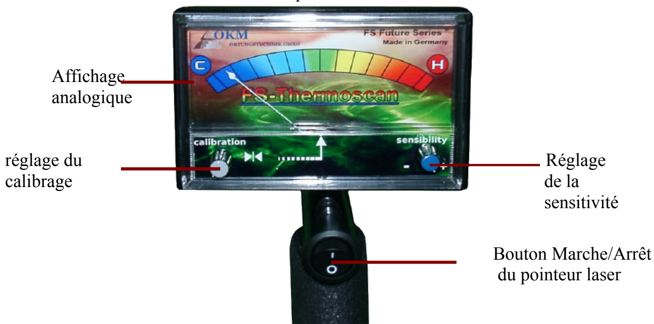
Illustration 7.35 : FS-Thermoscan vu de face
