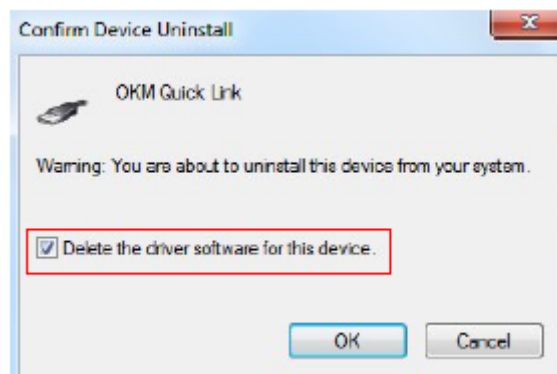
Illustration 2.37 : Désinstallez les pilotes USB sous Windows 7, étape 2
