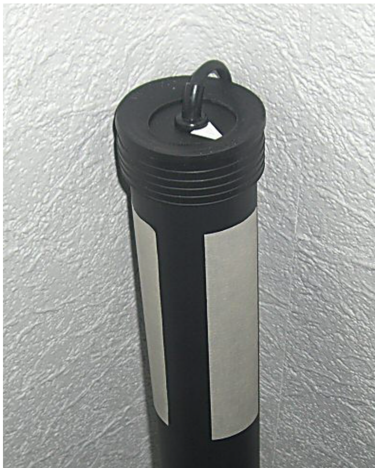
Illustration 9.2: ajout de repères sur le Super Sensor
